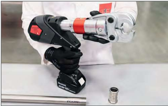
Preparazione della macchina pressatrice / Press machine preparation
