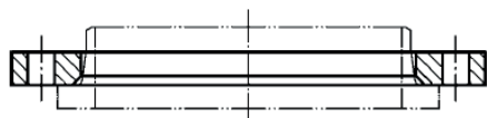
Type 04: Flangia a piastra mobile con colletto a saldare su collare Loose plate flange with weld-neck collar
