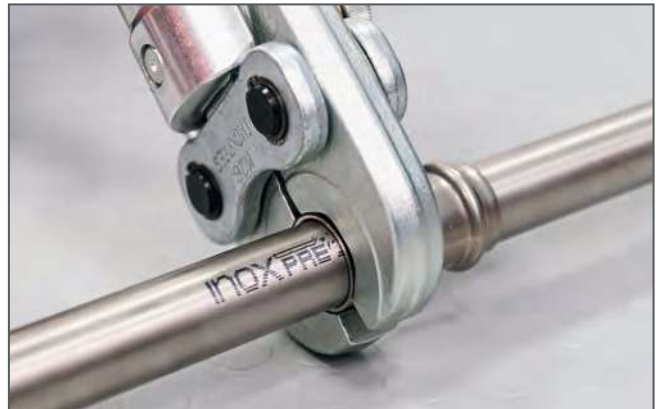
Assemblaggio attraverso pressatura / Making the press connection
