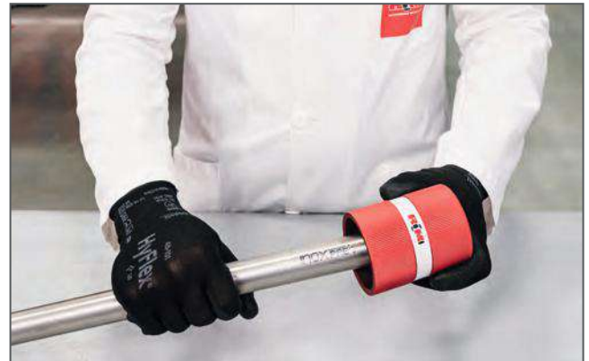
Sbavatura del tubo / Deburring the pipe
