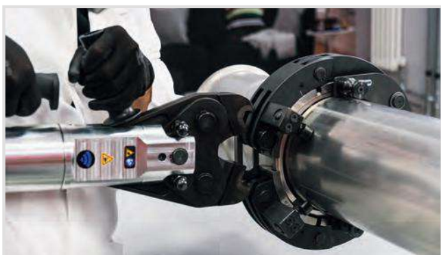
Assemblaggio pressatura n°1 / Press assembly phase 1
